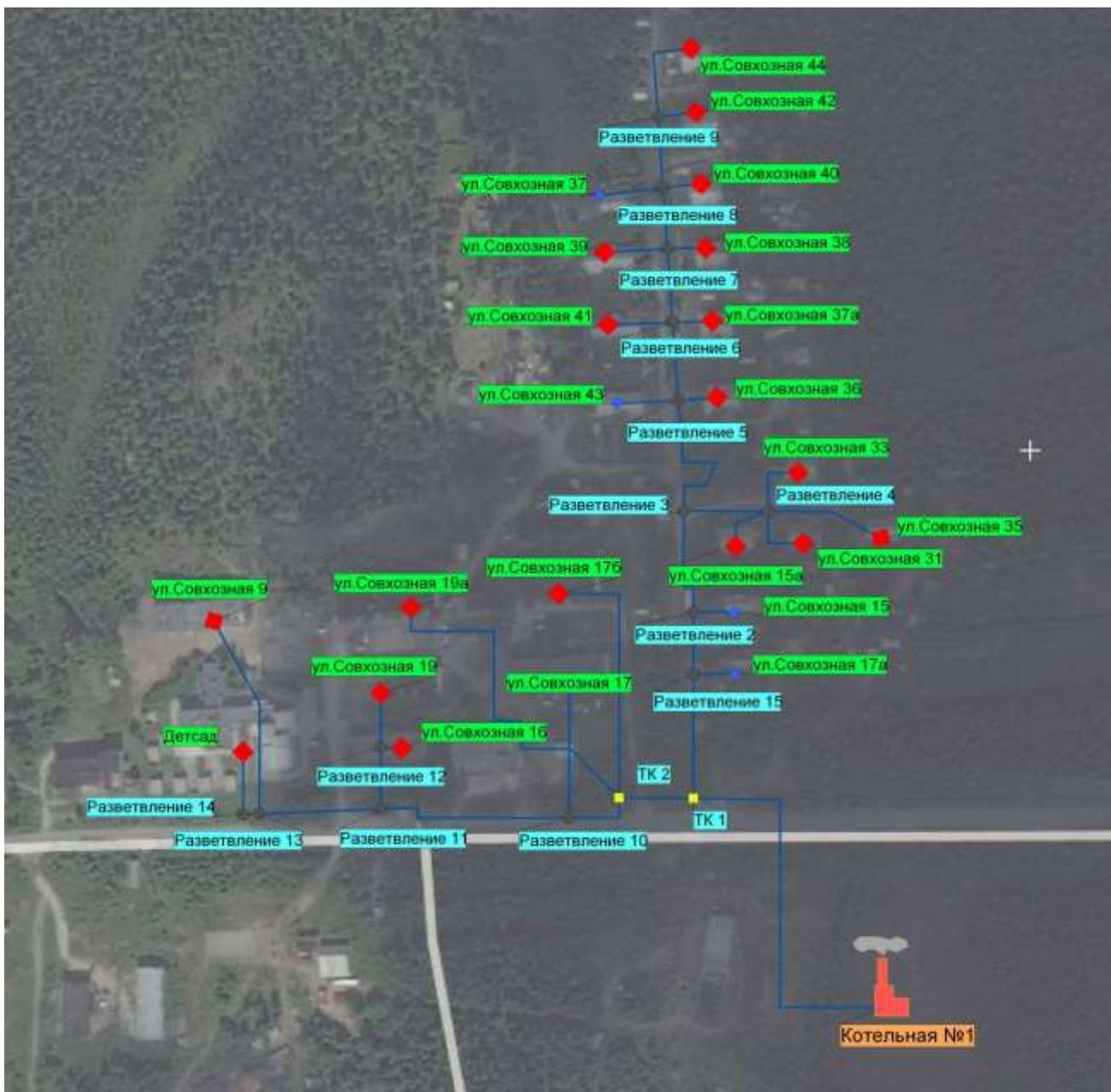
**Рисунок 2.1.16.1 Перспективная схема тепловых сетей от котельной № 1.**
