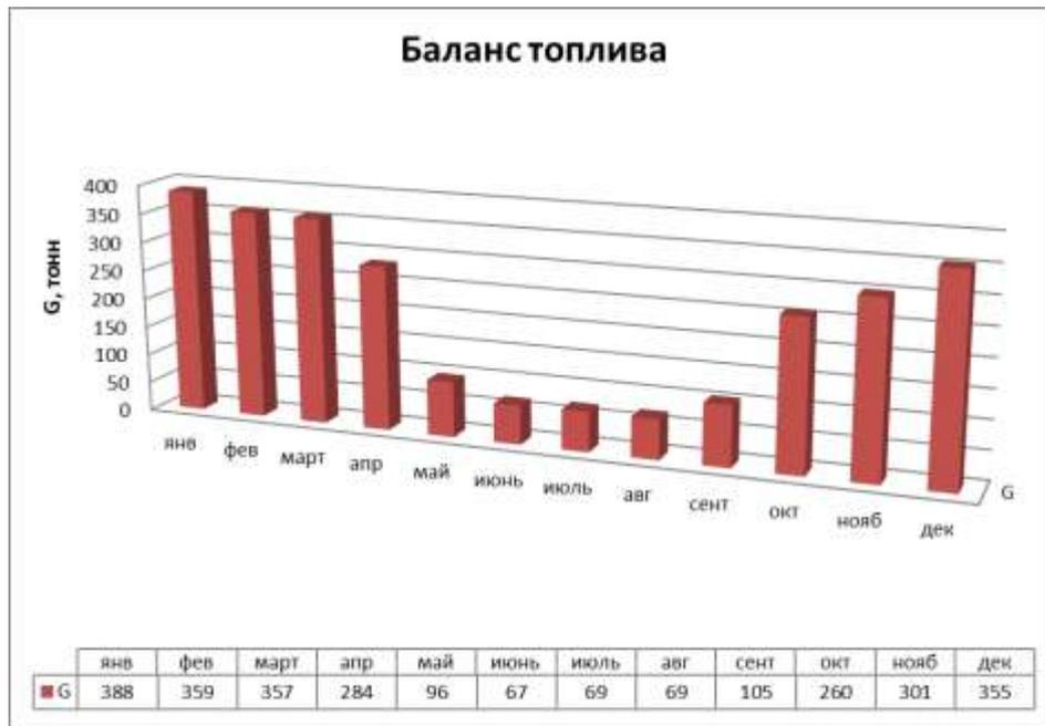
Рисунок 2.1.17.3 Топливный баланс котельной 3
